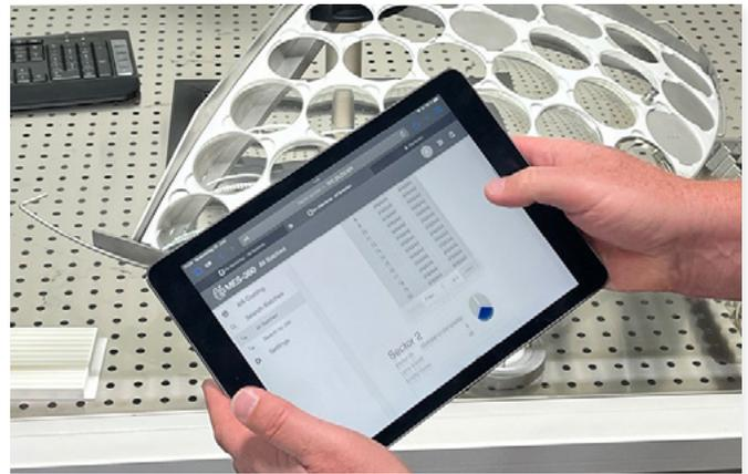
MES-360 Coating Batch, verfolgt Gläser während des Beschichtungsprozesses
