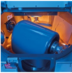
Die smarte B-Achse ermöglicht vorausschauende Wartung und verhindert Achsschäden durch ein Warnsystem
